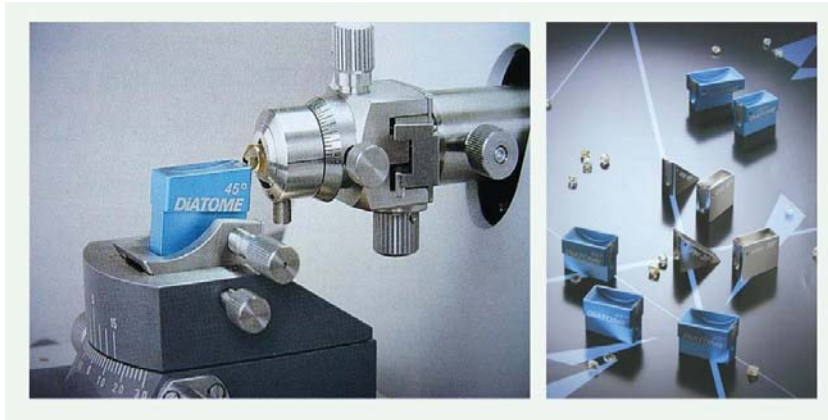
그림 8.8. 초박절편기에 다이아몬드칼의 장착(좌)과 종류(우).
