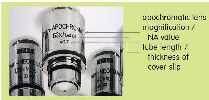
그림 3.8. 광학현미경의 대물렌즈와 특성 표시.
